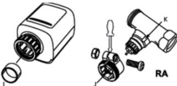
O adaptador fornecido é necessário para a instalação em válvulas Danfoss RA.
